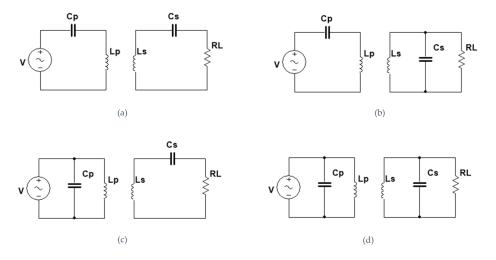
Figure 14. Classic or basic compensation topologies: (a) SS, (b) SP, (c) PS, and (d) PP.
